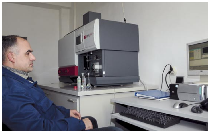
Извършване на физикохимичен контрол на продукти на корозия с атомно-абсорбционен спектрофотометър с индуктивно свързана плазма
