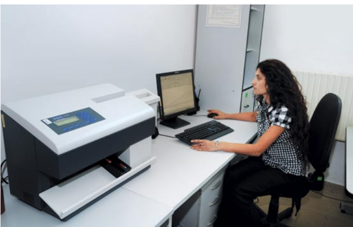
Контрол на индивидуалната ефективна доза от външно облъчване чрез измерване с термолуминесцентна дозиметрична система RADOS
