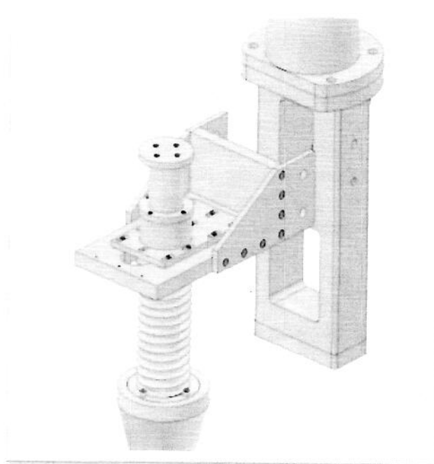
Фигура 1 INETEC центратори за монтаж на краката на манипулатора
