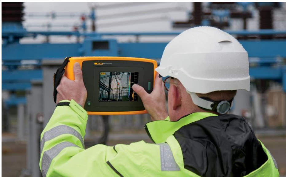
Снимка, направена на прецизния акустичен имиджър ii910, който открива частичен разряд в приложение с високо напрежение.
