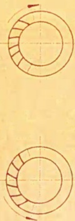
Установка вентилятора при различных направлениях вращения (вид со стороны входа воздуха)
