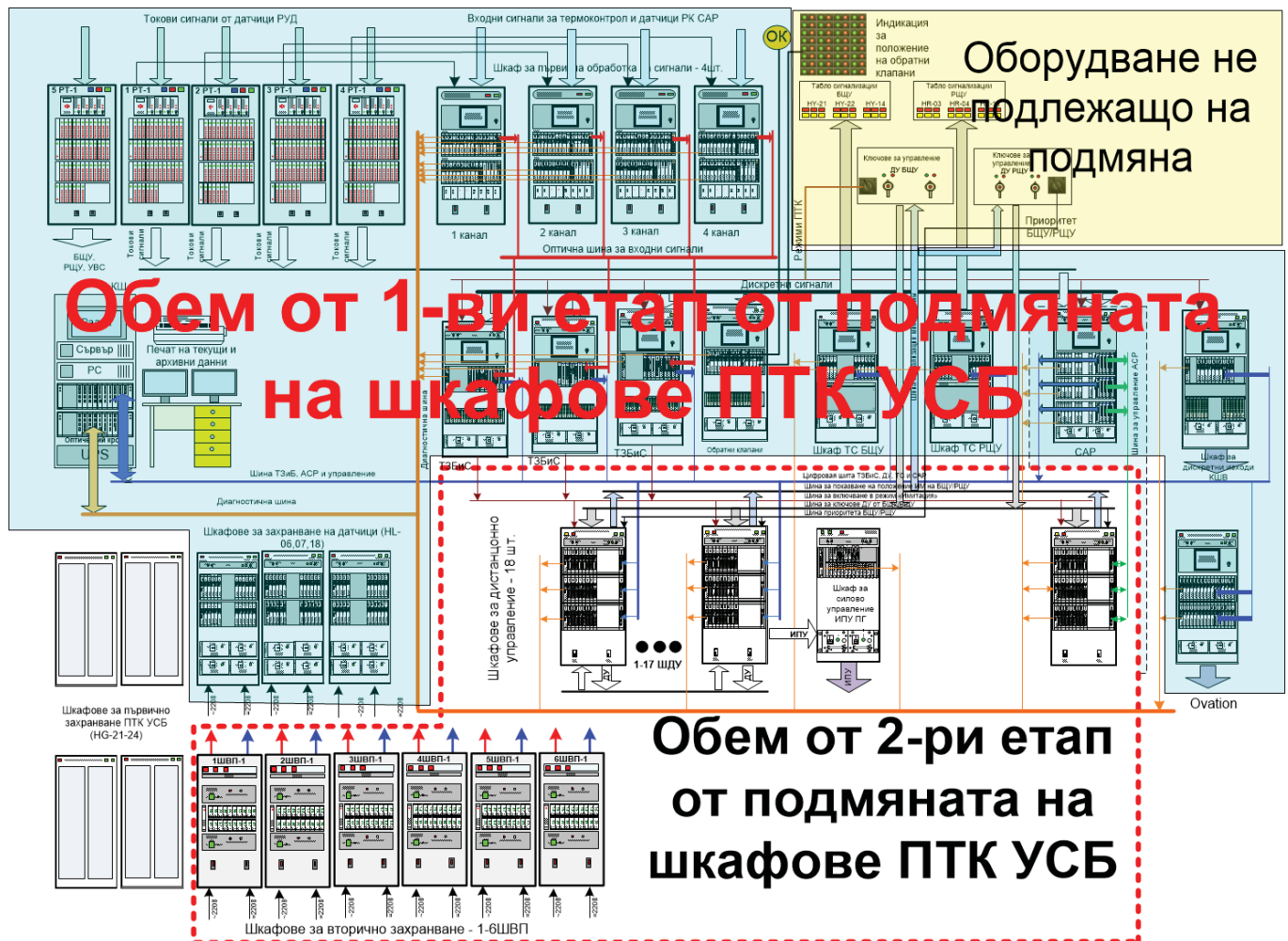
Фиг.В.1. Разделение на обема работи по замяната на шкафовете от гледна точка на функционалността
