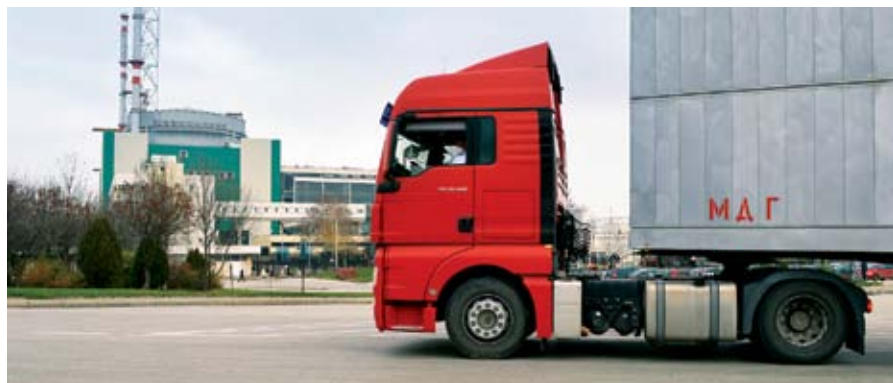
Мобилен дизелгенератор пристига, за да осигури аварийно електрозахранване на б енергоблок
