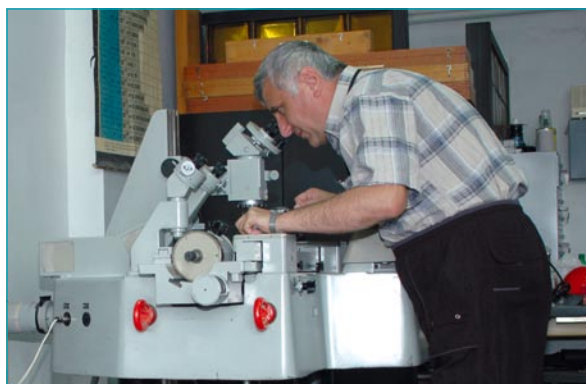
Работно място за проверка на калибри – лаборатория „Измерване на механични величини“
