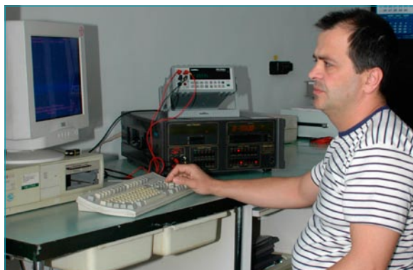
Работно място за калибриране на мултиметри – лаборатория „Електро- и радиоизмервания“
