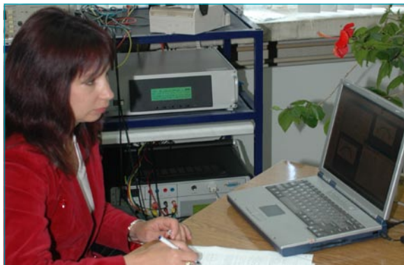
Автоматизирано работно място за проверка на електромери и преобразуватели на мощност – лаборатория „Електро- и радио измервания“
