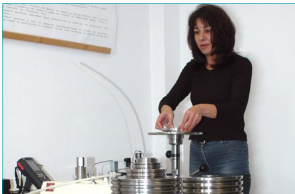
Работно място за калибrierане на еталони за налягане – лаборатория „Измерване на налягане, разход и ниво“
