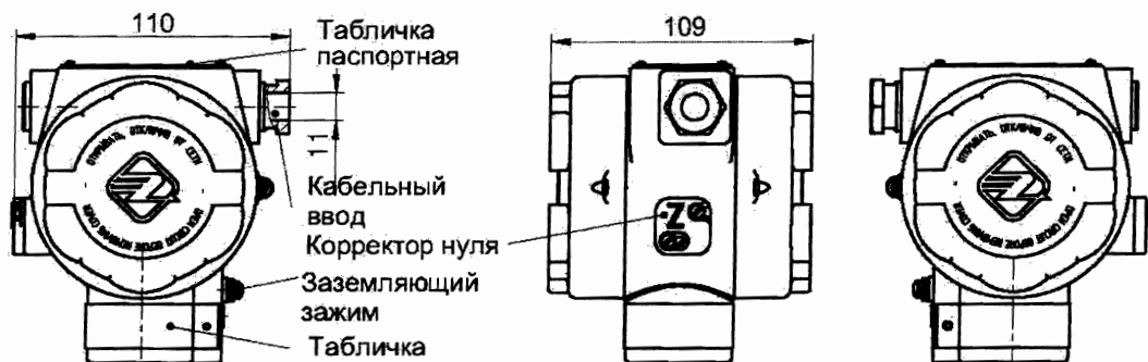
Исполнения общее и взрывозащищенное OExialICT5 X
